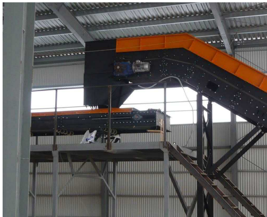
Рис. 7. Узел натяжения ленточного сортировочного конвейера.
