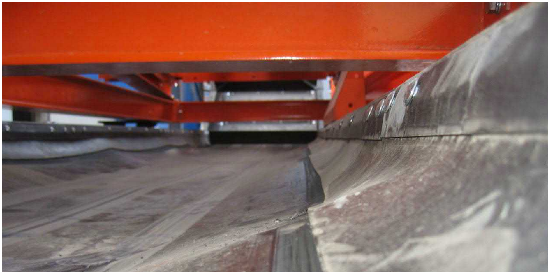
Рис. 8. Уплотнение по краям ленты ленточного конвейера
