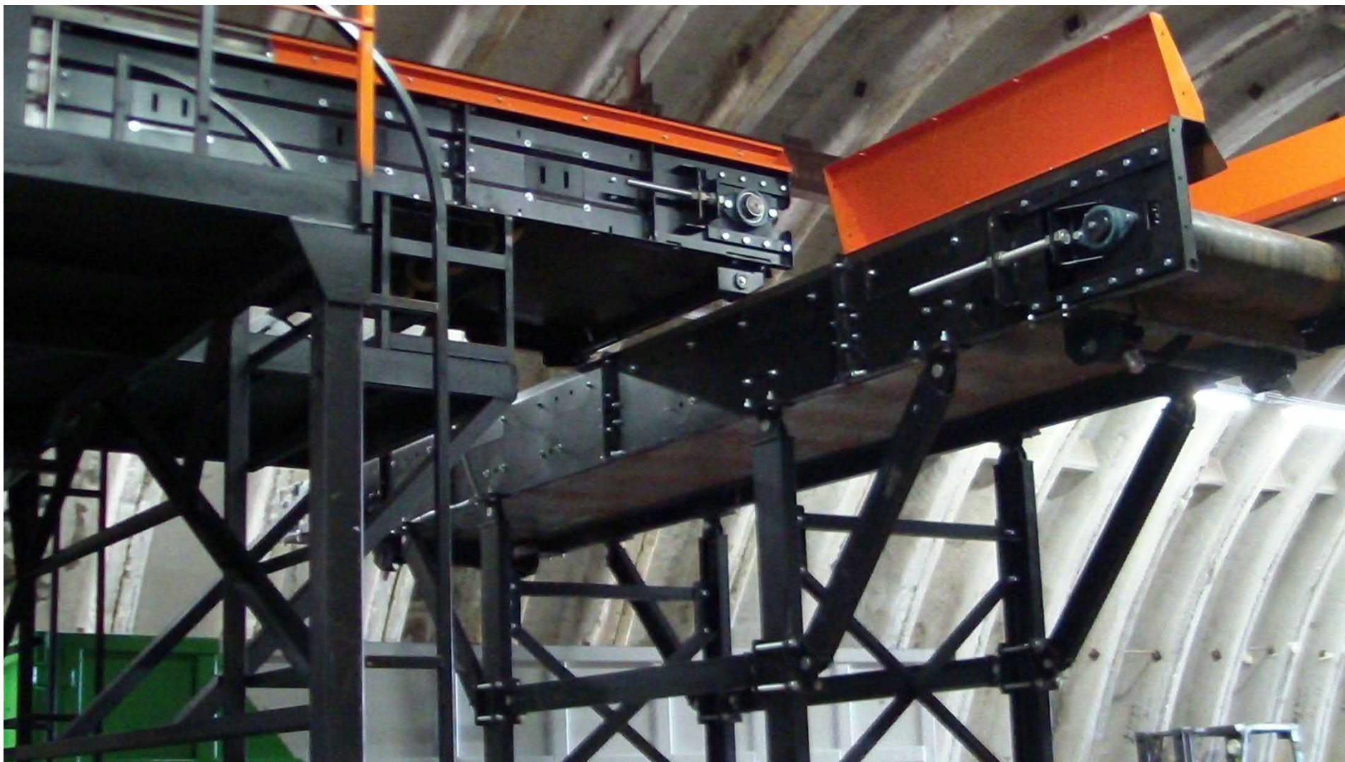
Рис.10. Очистные устройства ленточных конвейеров под натяжным барабаном.
